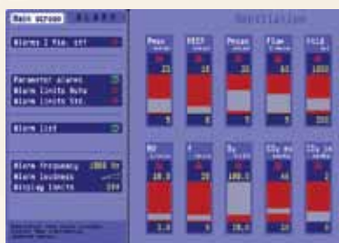
Окно регулировки тревог искусственной вентиляции легких
